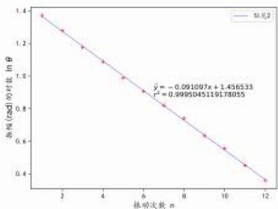
图 5: 阻尼 2 振幅随振动次数曲线图
