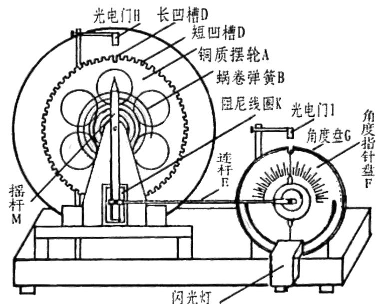
图 3: 波尔共振仪结构示意图
