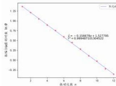
图 6: 阻尼 4 振幅随振动次数曲线图
