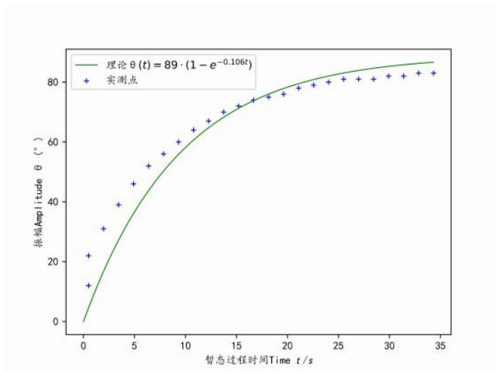
图 14: 受迫振动中暂态振幅与时间曲线图 (阻尼 4)
