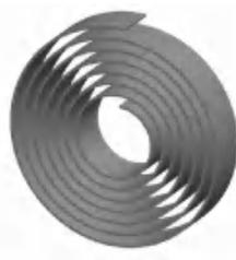
图 1: 平面涡卷弹簧构造
