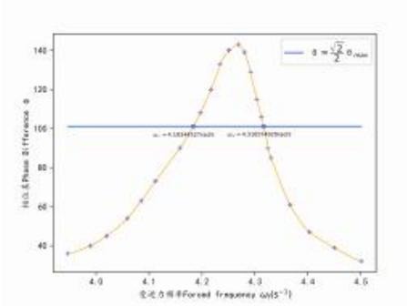
图 7: 阻尼 2 振幅与频率曲线图
