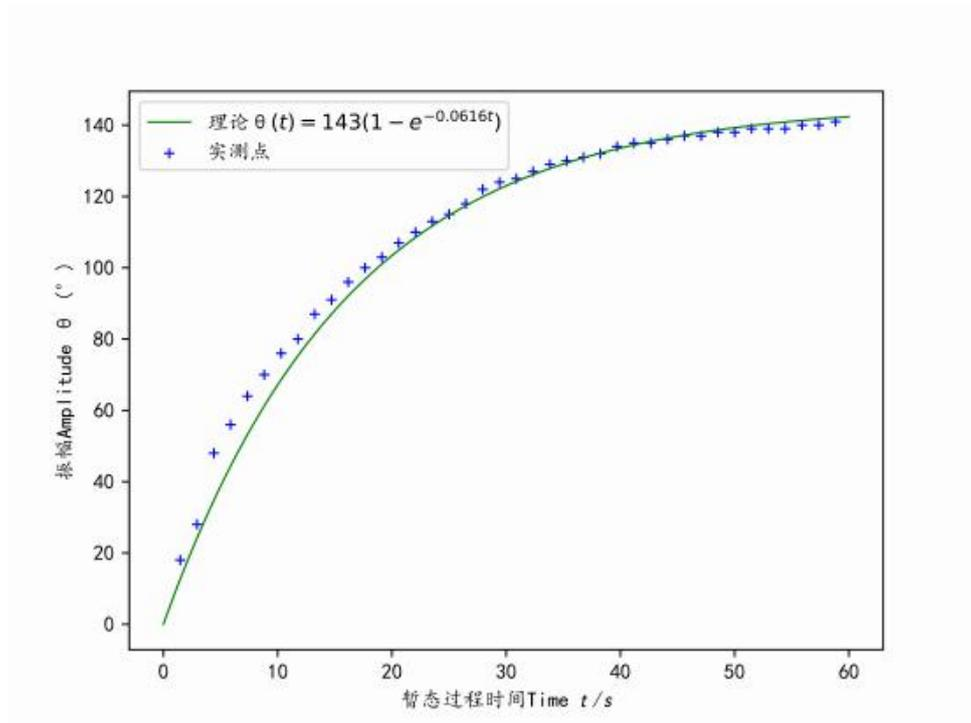
图 13: 受迫振动中暂态振幅与时间曲线图 (阻尼 2)
