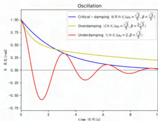
图 2: 不同阻尼系数下的振动曲线  $\theta(t)$
