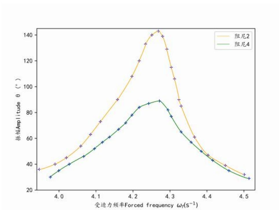
图 11: 不同阻尼系数下受迫振动振幅与强迫力频率关系图
